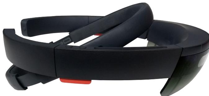
**Abbildung 2.3:** Microsoft HoloLens ist ein HMD AR-Gerät und verfolgt einen Optical-See-Through Ansatz.
