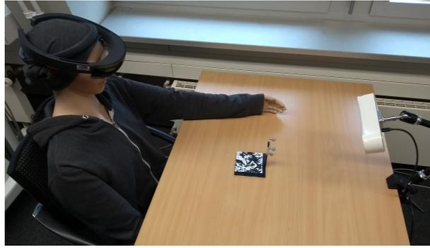
**Abbildung 4.4:** Aufbau des Registrierungsprozess: Ein Nutzer trägt eine HoloLens und fokussiert den Bild-Marker. Parallel dazu werden die passiven Reflektoren durch die Atracsys-Kamera getrackt.
